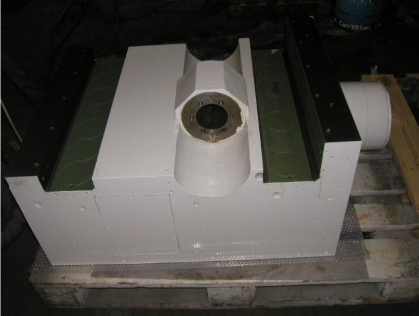
Applicazione TURCITE e raschiatura
